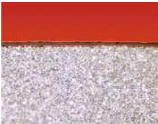
PVD nano structuur coating Met als basis een hoog Al Slijtvast VHM universeel micro substraat
