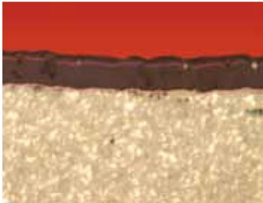
PVD meermalagen coating AITiN + TiAlSiN Hoog slijtvast VHM micro substraat
