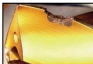
Uitbrokkeling aan de rondloopfases
