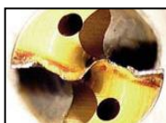
Uitbrokkeling aan de snijkant
